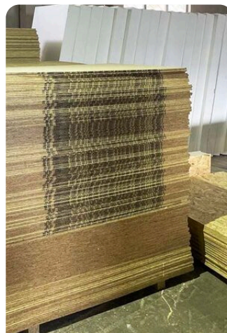
Плити OSB і блоки утеплювача, з яких роблять SIP-панелі, у цеху EurHome
